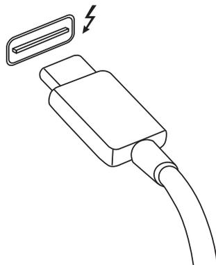
A ligação Thunderbolt utiliza uma porta USB do Tipo-C e é compatível com Thunderbolt, USB, DisplayPort e dispositivos com alimentação por USB-C. A porta Tipo-C é reversível; as ligações podem ser inseridas com qualquer um dos lados para cima.
