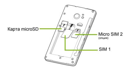
**Примечание:** В вашем смартфоне в зависимости от модели может быть одно или два гнезда SIM-карт.
